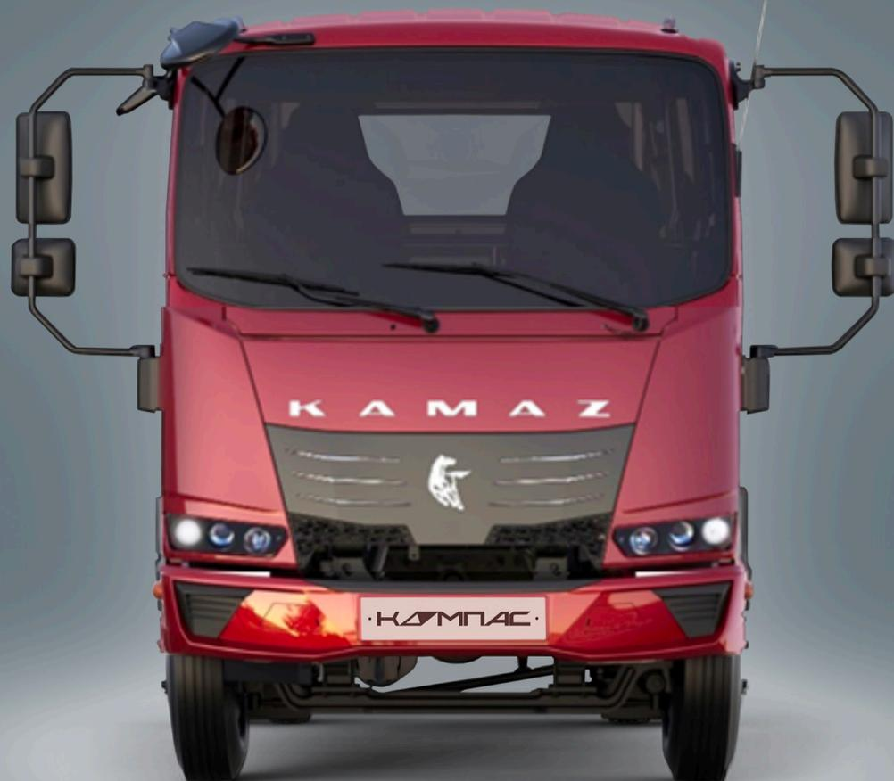
КОМПАС 5 — компактная и перспективная модель семейства — предлагает множество преимуществ для маневренного вождения и эффективной работы. На модели КОМПАС 5 полной массой до 3,5 т. и КОМПАС 6 — до 5,6 т. устанавливаются 4-цилиндровые дизельные двигатели КАМАЗ-580 объёмом 2,2 л, мощностью 122 л.с. и с крутящим моментом 320 Нм, а также 5-ступенчатая механическая коробка передач.
